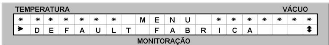
Caso tenha certeza que deverá recuperar os dados, utilize as teclas de **navegação (08)** e mude para a opção **(SIM)**. Confirme com a tecla **OK (07)** para executar a rotina conforme **Ex.**
