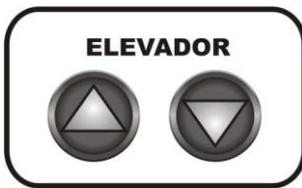
As teclas **ABRE (10)** e **FECHA (9)** do painel, acionam manualmente o elevador e sobrepõem as funções automáticas programadas na tecla **ELEV. (21)**. Estas teclas funcionam como uma chave interruptora. No primeiro toque **LIGA** e permanece ativada, no segundo toque **DESLIGA** e permanece desativada.
