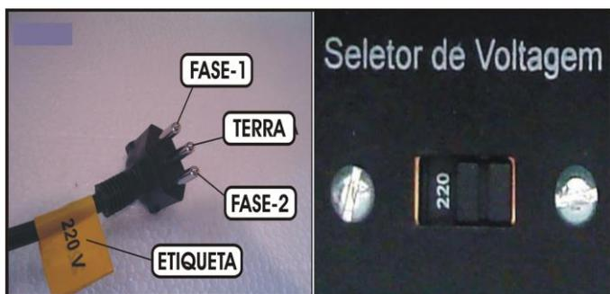
**3-1)** Verifique se a tensão de sua rede é a mesma da indicada na etiqueta de seu forno **FIG-1- Item (3)** e na chave seletora de tensão **FIG-1 – Item (4)**. **Verifique PG-32 - Item (14-3)**.
